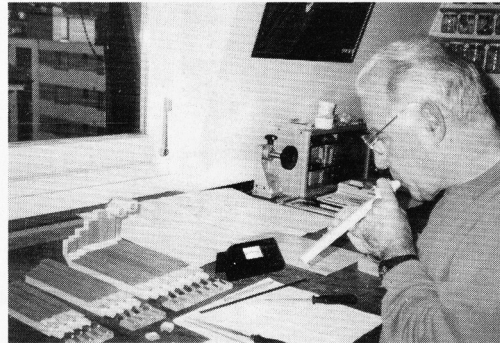
13 Celloregister wird angeblasen, vorgestimmt und intoniert
